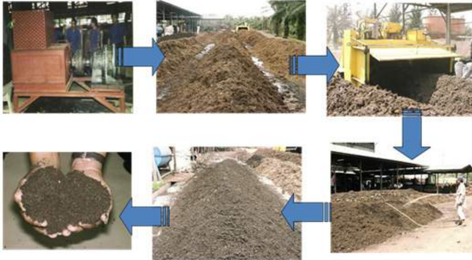
Gambar 7. Pembuatan kompos dari tandan kosong kelapa sawit
