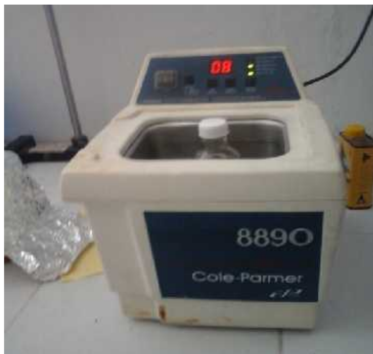
Gambar 3. Bath cleaner yang digunakan sebagai penghasil gelombang ultrasonic.
