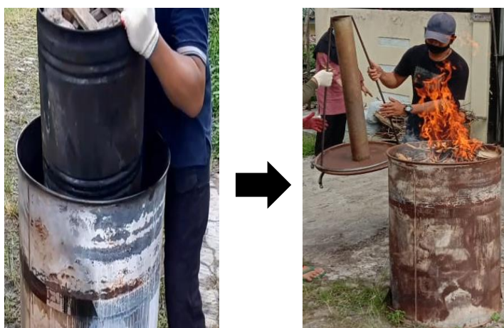
Gambar 6. Produksi arang dengan double-drum retort kiln .
