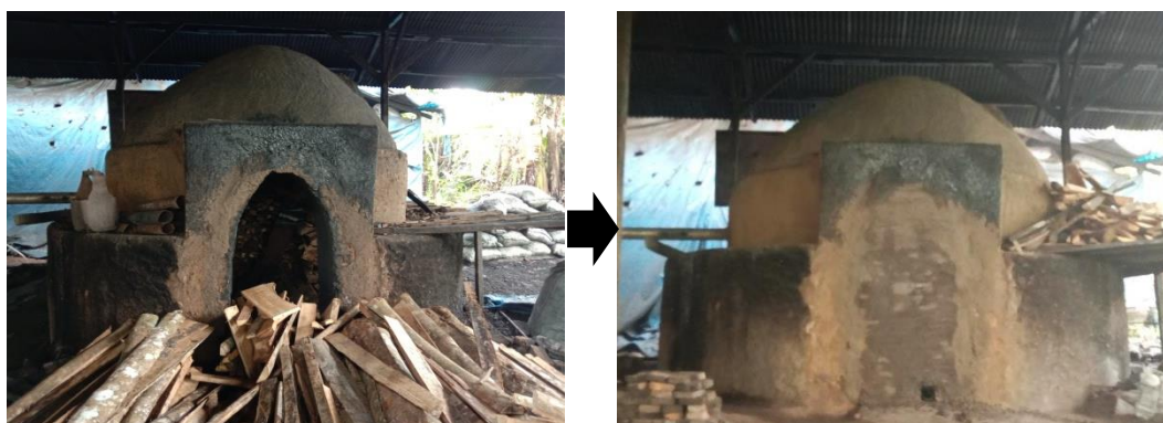
Gambar 5. Produksi arang dengan tungku kubah.
