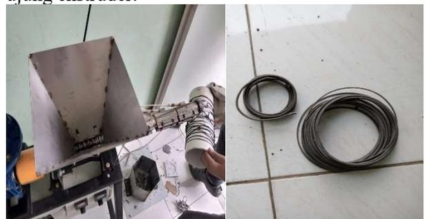
**Gambar 8.** Proses pembuatan filamen berbasis sampah plastik
