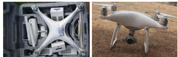
**Gambar 1.** UAV DJI Phantom 4 yang digunakan untuk pemetaan dan pengambilan gambar untuk kawasan wisata.
