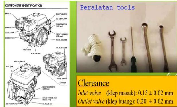
Gambar 4. Bagian – bagian komponen mesin, peralatan *tools* dan *clereance valve*
