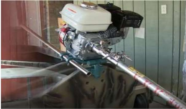
**Gambar 13.** Pengujian mesin tempel tipe *long shaft*
