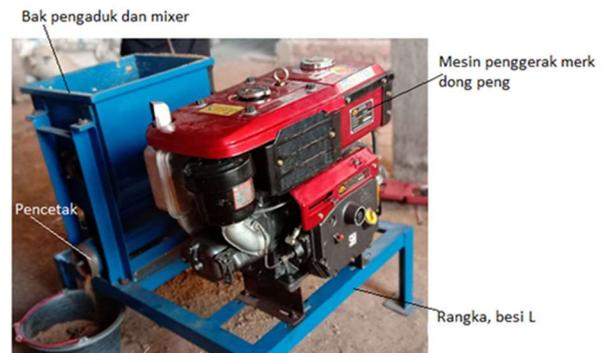
**Gambar 2.** Mesin pencetak pakan ternak pelet dengan sistem ekstruder
