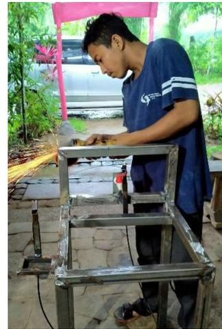
**Gambar 4.** Pembuatan Alat Cuci Tangan Higienis
