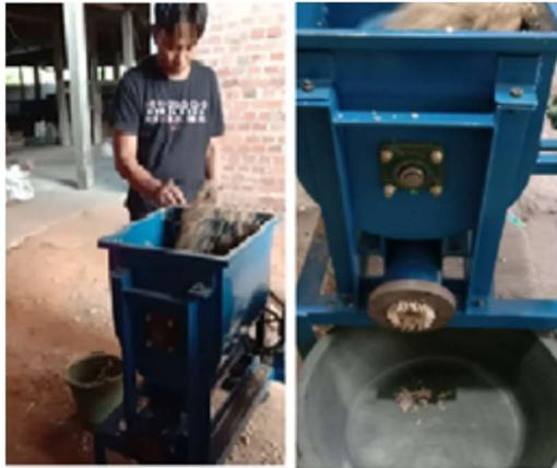
**Gambar 5.** Material onggok sudah melewati lobang sehingga tercetak dengan ukuran pendek
