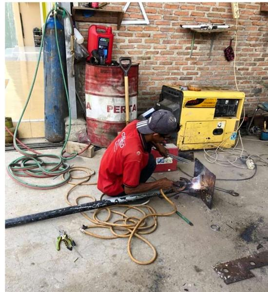
Gambar 3. Proses pembuatan dudukan panel
