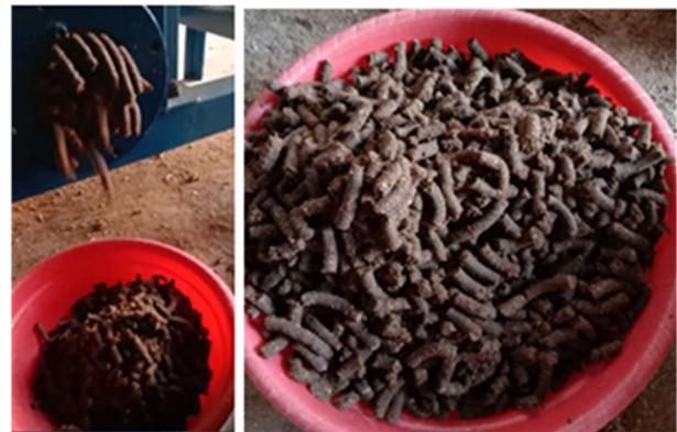
**Gambar 6.** Pakan ternak yang dicetak dengan mesin ekstruder berkapasitas 100 kg/jam
