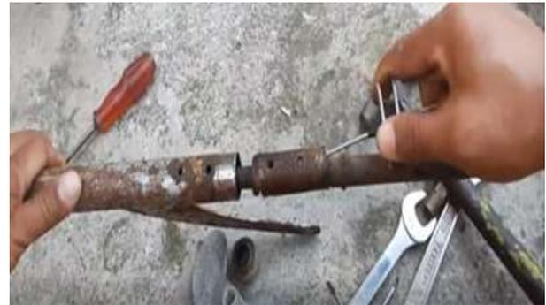
**Gambar 5.** Pelatihan perawatan poros (*shaft*) baling-baling
