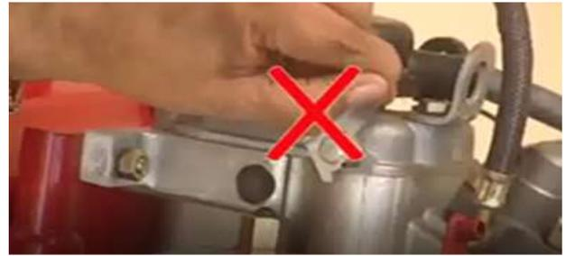
**Gambar 16.** Tidak mematikan mesin menggunakan pedal/tangkai gas (*decompression lever*), tapi harus tekan tombol *on/of*
