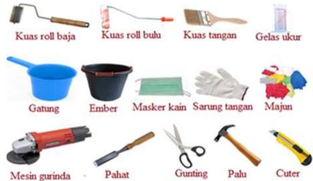
**Gambar 5.** Peralatan perlengkapan kerja fiberglass
