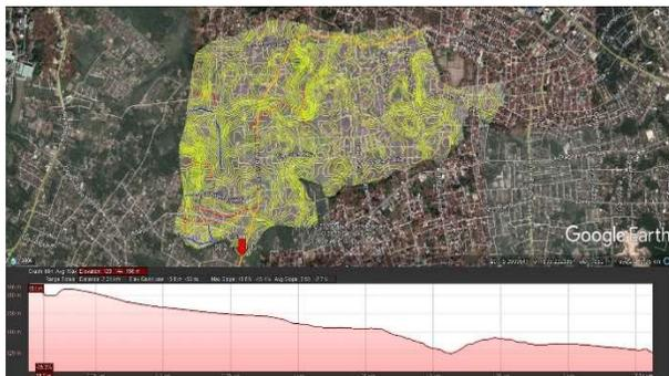
**Gambar 4.** Kontur Topografi wilayah Gunung Terang dan Profil kemiringan Jalan Purnawirawan Raya.
