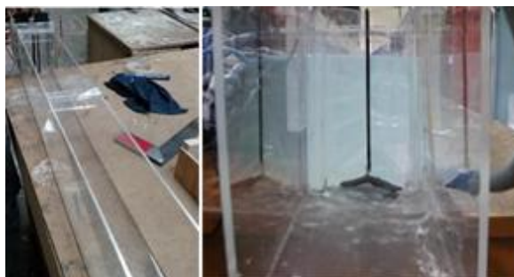
Gambar 4. Pengembangan Purwarupa Pintu Air dan Saluran Irigasi
