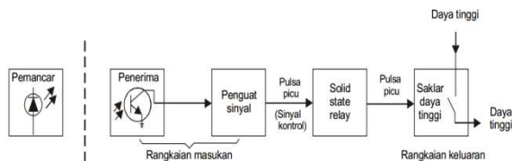
Gambar 1. Diagram blok saklar kendali cahaya.
