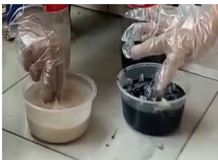
Gambar 6. Proses Fiksasi dengan kapur (kiri) dan tunjung (kanan)
