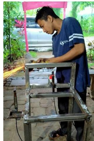
**Gambar 4.** Pembuatan Alat Cuci Tangan Higienis
