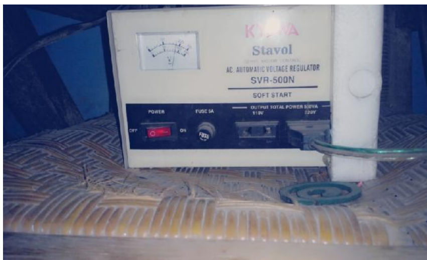
Gambar 5. Tegangan listrik terukur sebesar 200 Volt
