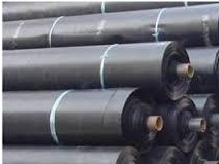
Gambar 3. Plastik HDPE geomembran 0,5 mm untuk melapisi kolam
