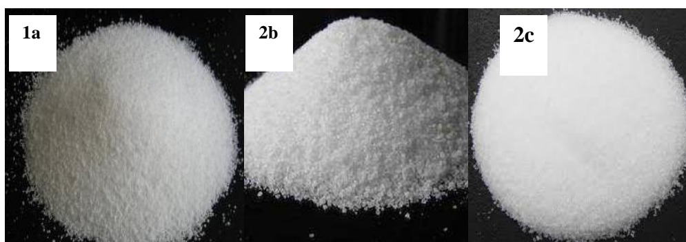
Gambar 1. Bahan-bahan pembeku karet yang digunakan a. \text{CaSO}_4 ; b. \text{K}_2\text{SO}_4 \cdot \text{Al}_2(\text{SO}_4)_3 \cdot 24\text{H}_2\text{O} ; c. \text{CO}(\text{NH}_2)_2
