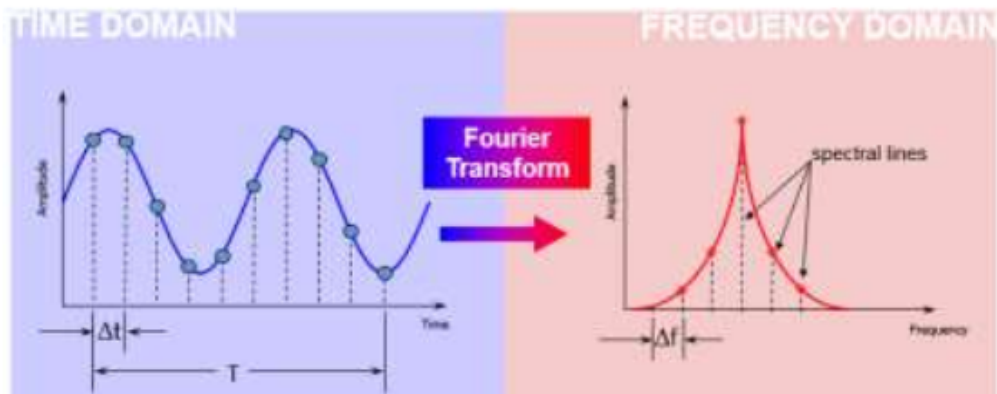
Gambar 3.14. Proses transformasi spektrum dari time domain ke frekuensi domain menggunakan Fourier Transform (FT) (sumber dari: https://community.plm.automation.siemens.com ).
