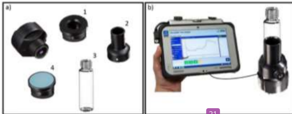
Gambar 5.4. (a) Aksesoris alat MicroNIR: (1) collar; (2) vial support; (3) 5 mL vial holder; dan (4) windowed collar. (b) Proses pengambilan spektra (diadaptasi dari Correia et al. , 2018).
