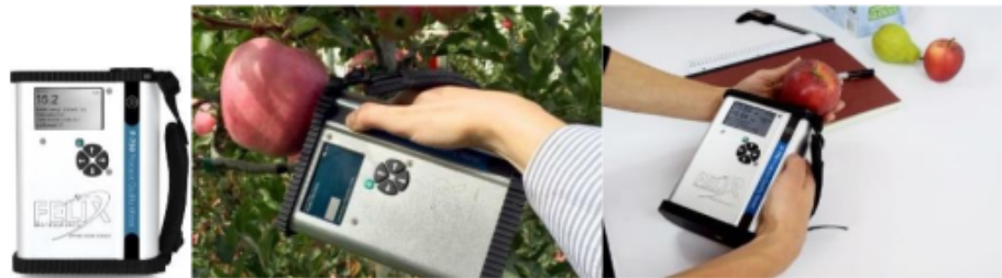
Gambar 3.2 Pengukuran atribut mutu buah secara on-plant dan off-plant dengan spektrometer portabel ( https://www.felixinstruments.com/food-science-instruments/portable-nir-analyzers/f-750-produce-quality-meter/ ).
