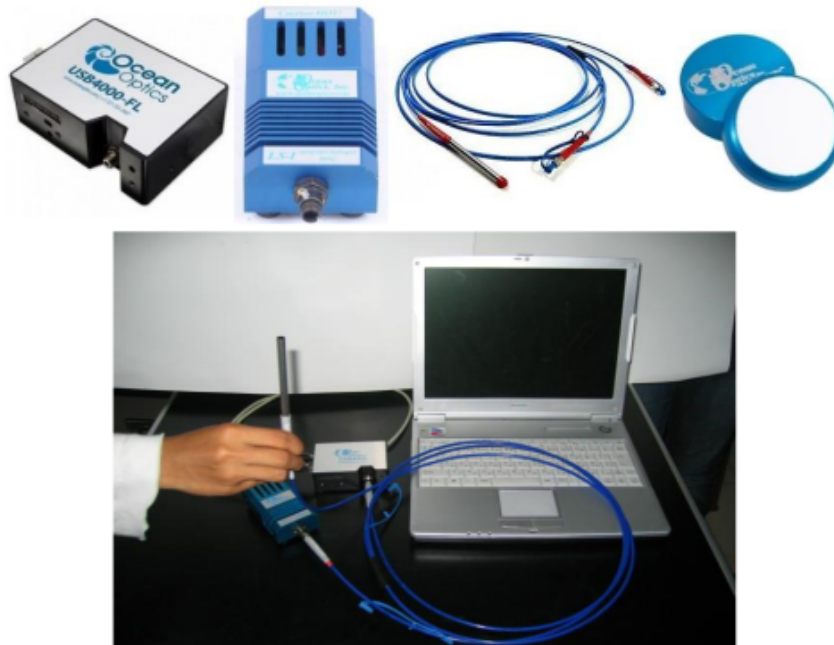
Gambar 3.4 Komponen dasar NIR spectroscopy portabel di Jurusan Teknik Pertanian, Fakultas Pertanian, Universitas Lampung. Gambar atas: dari kiri ke kanan: spektrometer, sumber cahaya, fiber optik dan reference standard . Gambar bawah: NIR spectroscopy portabel yang sudah dirakit dan siap digunakan.
