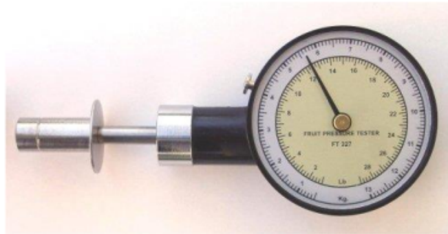
Gambar 2.7 FT Fruit Pressure Tester dengan probe yang dilengkapi alat pengukur pounds-force ( http://www.facchinisrl.eu/pen.htm ).
