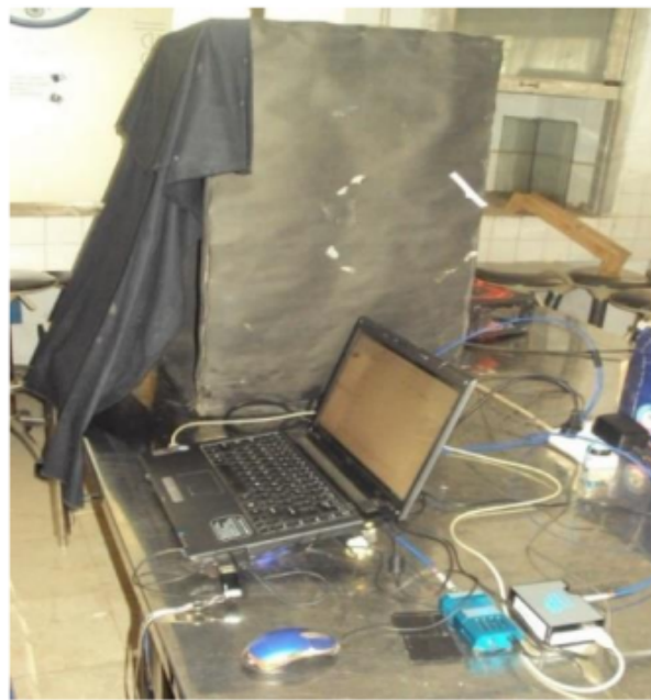
Gambar 3.17 Pengambilan spektra buah-buahan menggunakan NIR spectroscopy portabel yang dilengkapi dengan kotak hitam (Sumber: Dokumen Penulis).
