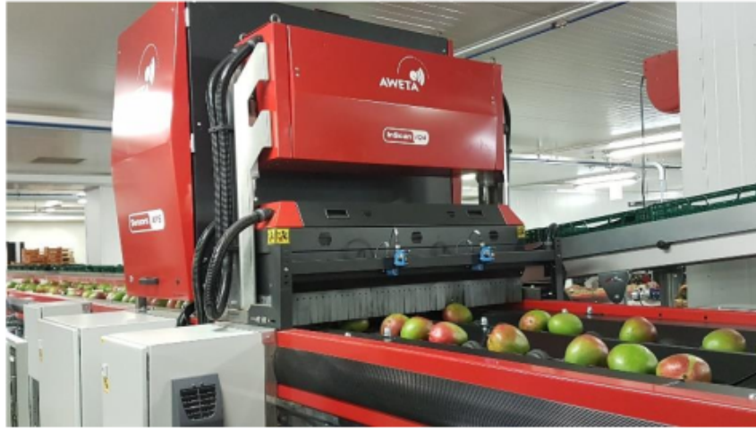
Gambar 2.9 Pengukuran atribut mutu internal buah menggunakan mesin sortasi yang bekerja menggunakan NIR spectroscopy .
