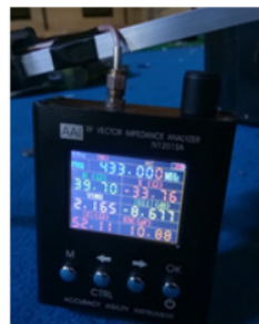
Gambar 8. hasil pengukuran menggunakan RF vector impedance analyzer
