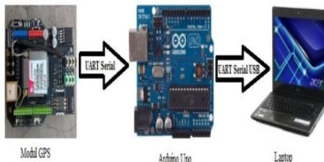
Gambar 3. Komunikasi UART antara Modul GPS, Arduino Serta Laptop
