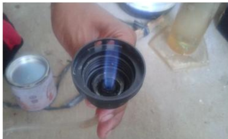
Gambar 5. Nyala Api Biogas
