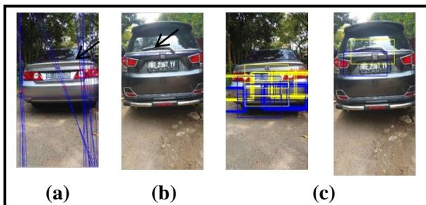
Gbr .3 (a) Titik Garis dibawah Plat (b) Titik Garis di atas Plat (c) Hasil Pemotongan
