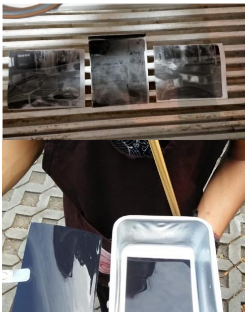
Gambar 12. Hasil ujicoba penggunaan BPU di dalam ruangan, gambar terlihat normal (atas) dan di luar ruangan, gambar tidak terlihat (bawah)
