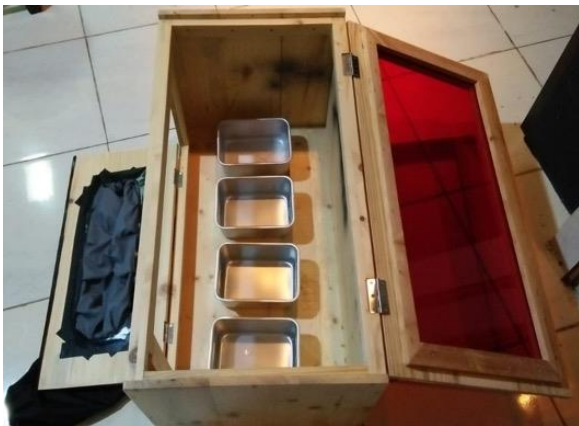
Gambar 7. BPU dan kelengkapannya dalam kondisi terbuka
