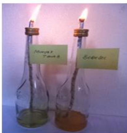
Gambar 5. Uji nyala dan kapilaritas biodiesel dengan lampu minyak tanah
