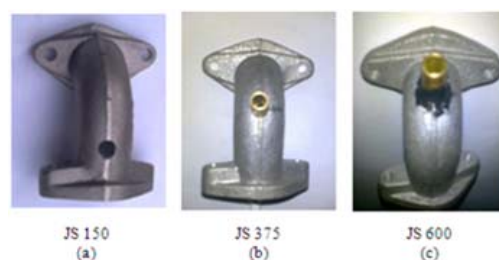
Gambar 1.a. Hasil pengeboran intake manifold JS 150 b. Pemasangan neeples pada intake manifold JS 375 c. Bentuk jadi intake manifold JS 600
