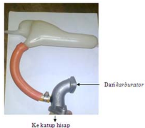
Gambar 2. Bentuk jadi intake manifold setelah dihubungkan dengan Tabung induksi YEIS
