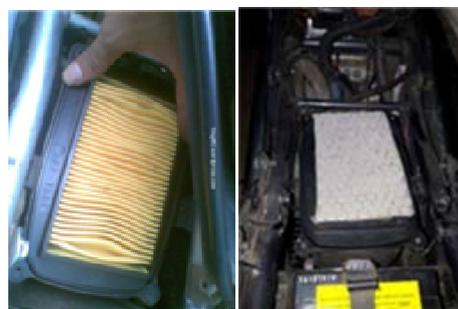
Gambar 1. *Filter* udara dan *fly ash* yang terpasang
