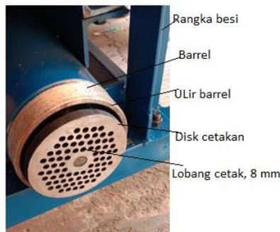
Gambar 7. Pencetak pelet berukuran diameter 8 mm
