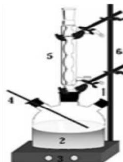
Gambar 1. Peralatan pembuatan MES: (1) inlet bahan, (2) labu leher tiga, (3) *hot plate magnetic stirrer*, (4) termometer, (5) pendingin balik, (6) statif
