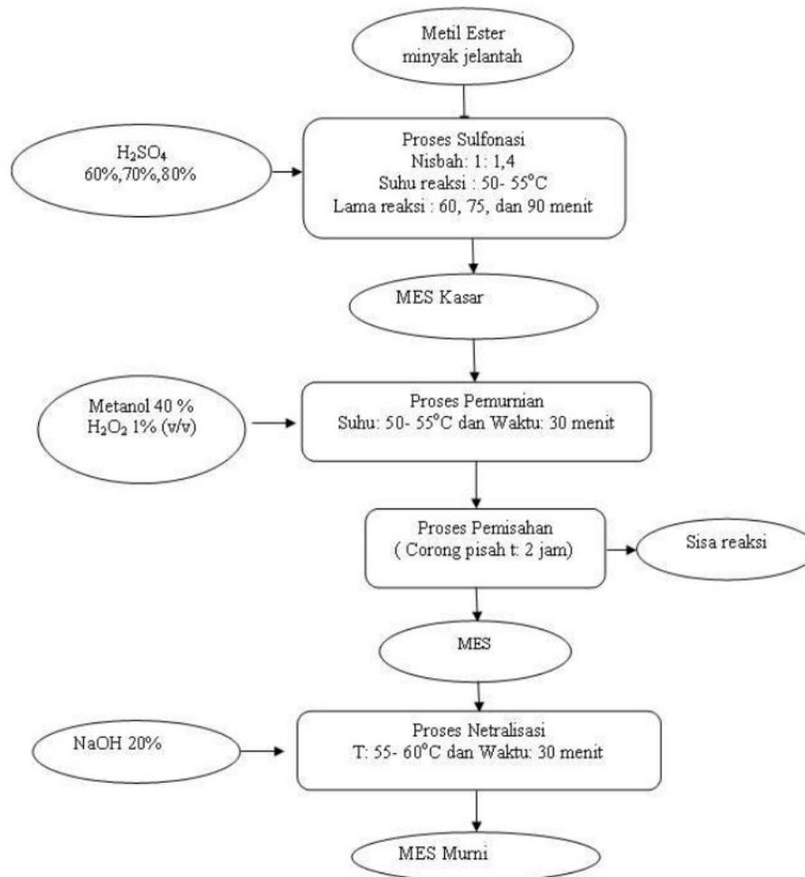
Gambar 2. Diagram alir proses tahapan penelitian pembuatan MES dari minyak jelantah dengan menggunakan H<sub>2</sub>SO<sub>4</sub> (Rivai, 2004 yang dimodifikasi)
