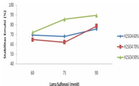
Gambar 4. Grafik hubungan lama sulfonasi dan konsentrasi  $H_2SO_4$  terhadap stabilitas emulsi MES dari minyak jelantah
