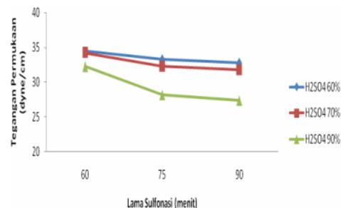
Gambar 3. Grafik hubungan lama sulfonasi dan konsentrasi H<sub>2</sub>SO<sub>4</sub> terhadap tegangan permukaan MES dari metil ester minyak jelantah
