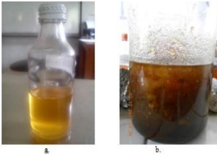
Gambar 2. Hasil transesterifikasi minyak jelantah menghasilkan a. Biodiesel (Ester Metil), b. Gliserol
