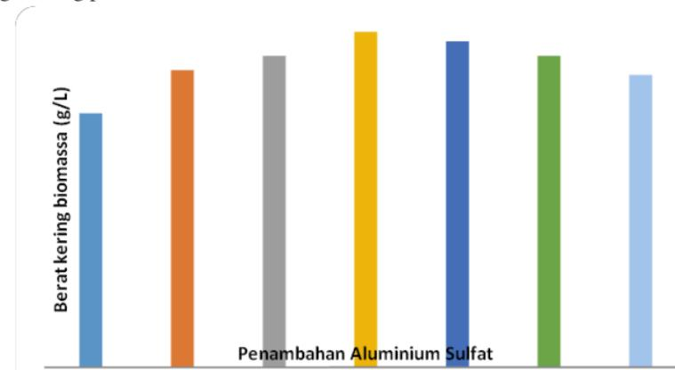
Gambar 4. Perolehan biomassa kering dengan pemanenan menggunakan konsentrasi flokulasi ( $\text{Al}_2\text{SO}_4)_3$  yang berbeda
