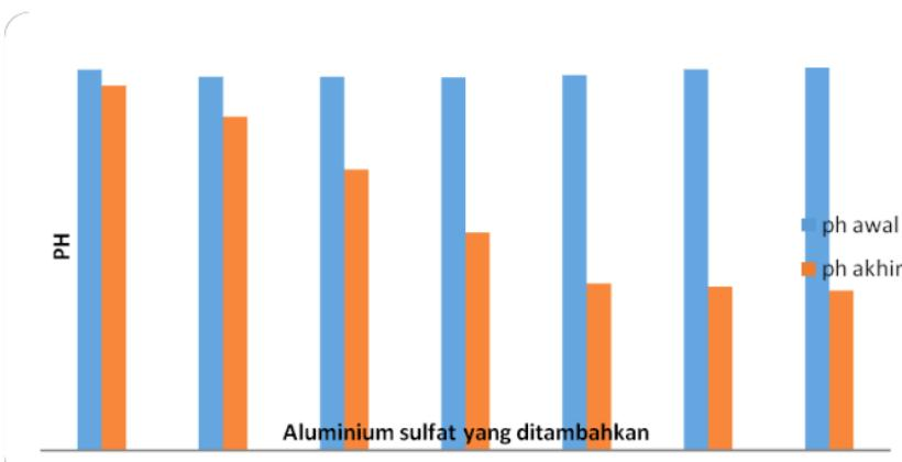
Gambar 2. pH awal dan akhir setelah penambahan flokulan ( $\text{Al}_2\text{SO}_4$ )<sub>3</sub>
