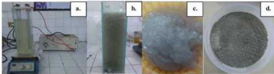
Gambar 4. Sintesis Aluminosilikat dengan metode elektrolisis, (a) reaktor elektrolisis; (b) hasil elektrolisis; (c) gel hasil sintesis; (d) aluminosilikat
