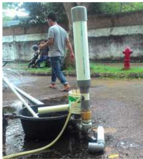
Gambar 5. Model pompa tanpa motor ( hydram pump ) yang dirancang.
