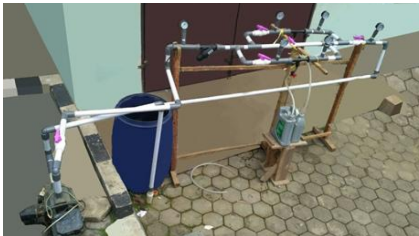
Gambar 2. Alat Fertigasi Hasil Penelitian Menggunakan Dua Venturimeter Dirangkai Paralel
