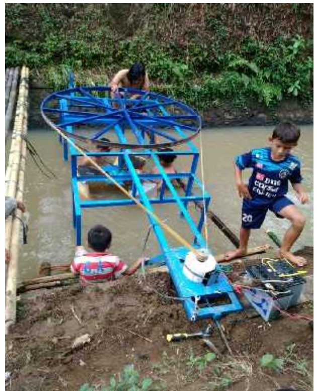
Gambar 4. Pengujian model sistem pembangkit listrik menggunakan turbin helik di saluran irigasi Way Tebu.
