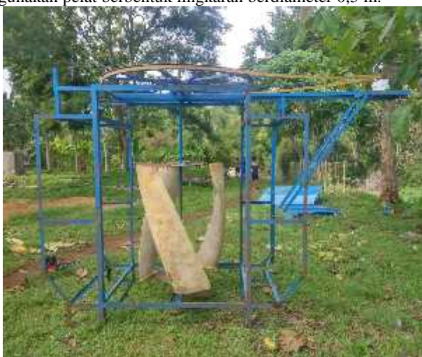
Gambar 3. Model sistem pembangkit listrik menggunakan turbin helik menggunakan bentuk sudu NACA 0033.
