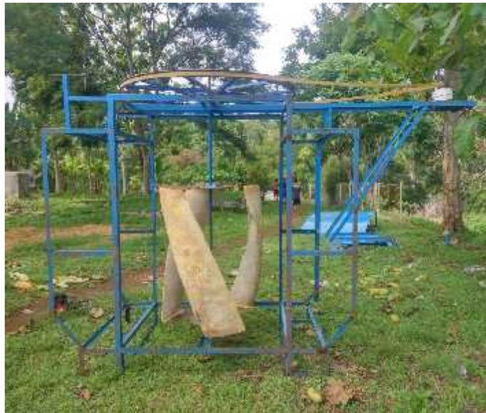
Gambar 3. Sistem pengujian turbin helik untuk model sistem pembangkit listrik yang diuji di saluran Way Tebu.
