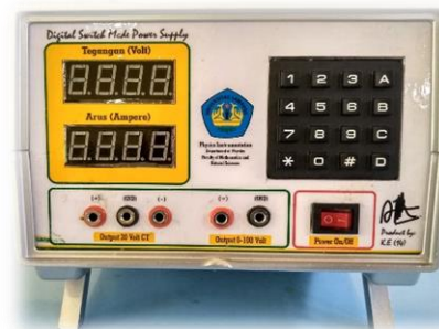
Gambar 6. Realisasi catu daya dengan metode SMPS berbasis arduino
