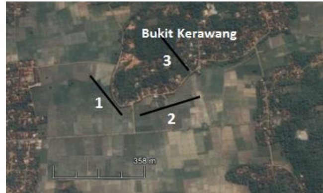
Gambar 3. Posisi 3 lintasan ukur geolistrik 2D
