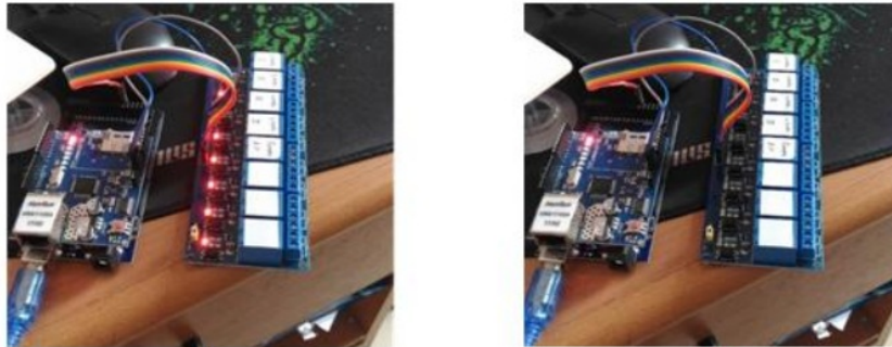
1 Gambar 4. (a) Rangkaian Relay dalam Keadaan Terbuka ( Normally Open ) dan (b) Rangkaian Relay dalam Keadaan Tertutup ( Normally Close )
