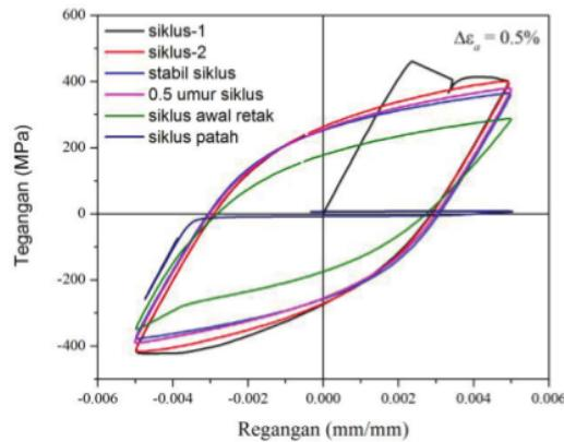
**Gambar 6.** Evolusi perubahan kurva histerisis tegangan-regangan pada amplitudo regangan 0.005 mm/mm.
