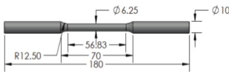
Gambar 1. Bentuk dan ukuran spesimen uji tarik
