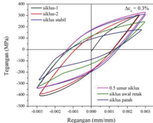
**Gambar 5.** Evolusi perubahan kurva histerisis tegangan-regangan pada amplitudo regangan 0.003 mm/mm.
