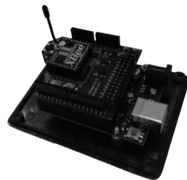
Gambar. 2 Nodal nirkabel terbuat dari modul Xbee dan arduino.
