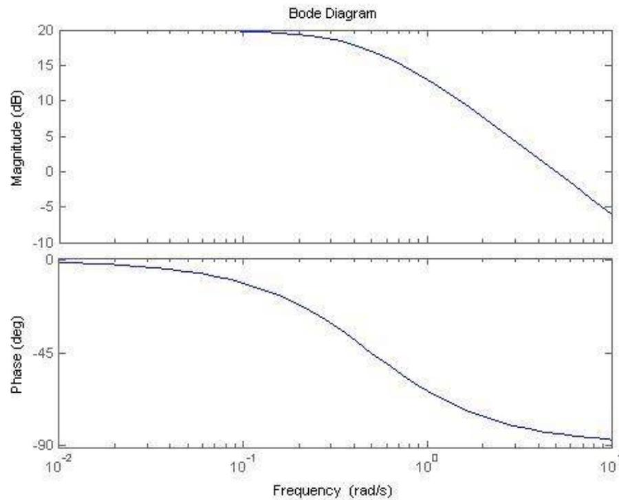
**Gambar VII.9 Plot Bode system  $G(s)$  pada contoh 1**
