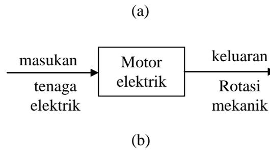
**Gambar I.1 Representasi sistem dengan sebuah kotak**
