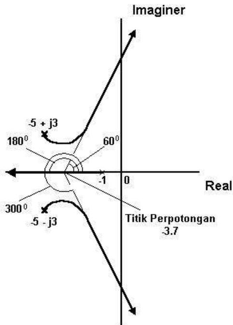
**Gambar VI.8 Asintot-asintot dengan  $n = 3$ , dan  $m = 0$ .**
