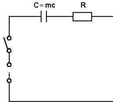
**Gambar II.13 Kesetaraan sistem termal dan elektrik soal contoh 5**
