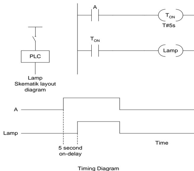
**Gambar IX.8 Pewaktu *On-Delay*.**
