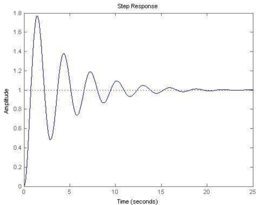
**Gambar VIII.12 Respon Sistem dengan Kendali Proporsional plus Integral**
