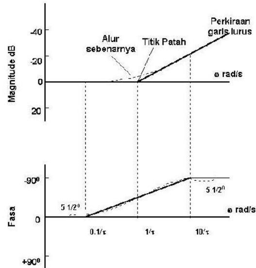
**Gambar VII.6 Plot Bode untuk sebuah nol real**
