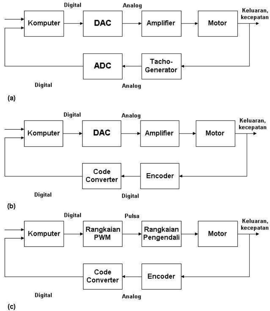
**Gambar X.7 Kendali kecepatan motor d.c.**
