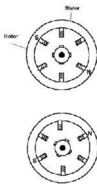
**Gambar VIII.39 Motor langkah.**
