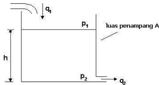
**Gambar II.9 Kapasitansi hidrolis.**
