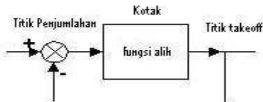
**Gambar V.1 Bagian-bagian dari diagram kotak.**
