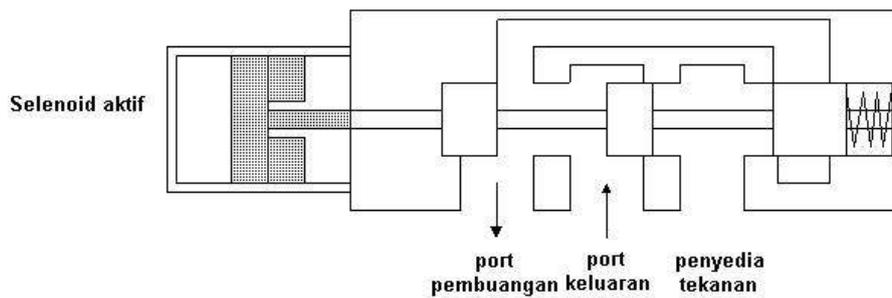
**Gambar VIII.41 Katup solenoid.****Sumber Kepustakaan :**
