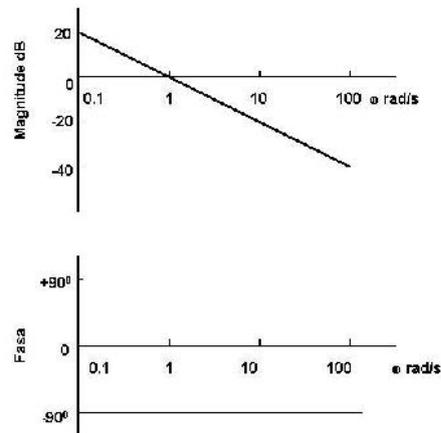
**Gambar VII.2 Plot Bode untuk kutu pada sumber (asal)**
