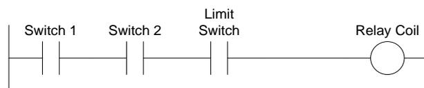
**Gambar IX.17 Logika Diagram Tangga untuk Rele Masukan.**
