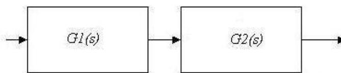
**Gambar V.3 Sistem dengan elemen yang disusun secara seri.**
