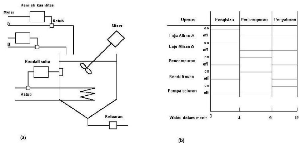
Gambar IX.5 (a) Pencampuran zalir, (b) Diagram waktu.
