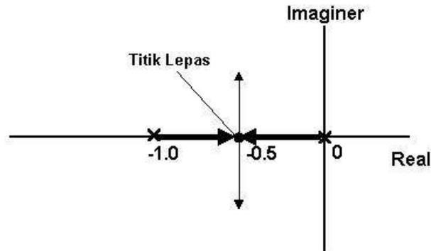
**Gambar VI.9 Titik pecah  $G_o(s) = K / s(\sigma + 1)$ .**
