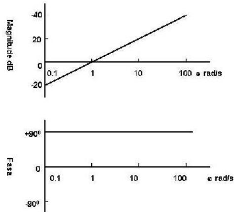
**Gambar VII.3 Plot Bode untuk nol pada sumber (asal)**
