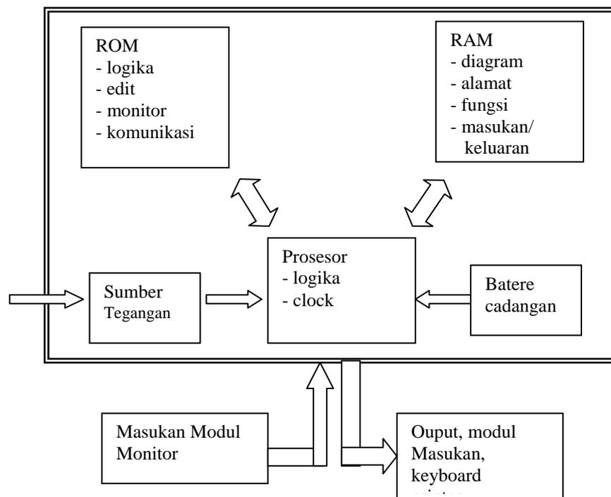
**Gambar IX.7 Diagram blok fungsi komponen CPU PLC.**
