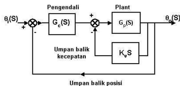
**Gambar VIII.23 Sistem dengan umpanbalik kecepatan dan posisi.**
