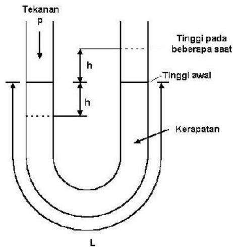
**Gambar II.15 Sistem hidrolik tabung U untuk soal nomor 2.**
