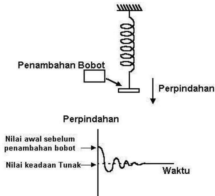
**Gambar III.1 Tanggapan peralihan dan keadaan tunak pada sistem pegas.**
