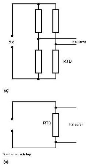
**Gambar VIII.32 Rangkaian RTD: (a) jembatan, (b) arus tetap.**
