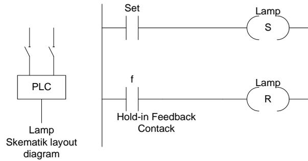
**Gambar IX.13 Pengunci menggunakan kumparan set dan reset.**
