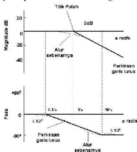
**Gambar VII.5 Plot Bode untuk sebuah kutub real**
