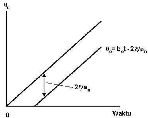
**Gambar IV.10** Tanggapan kondisi tunak dari sistem orde-dua untuk masukan tanjak.
