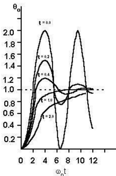
**Gambar III.9** Tanggapan sistem orde-2 untuk masukan undak.
