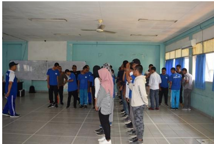
Gambar 9. Setting pemebanan untuk 40 orang pada pelat difokuskan diatas balok anak menyilang dibawah pelat.
