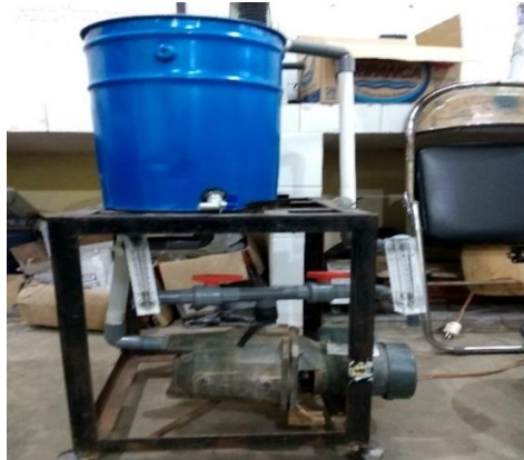
Gambar 2. Alat instalasi sistem quenching tersirkulasi
