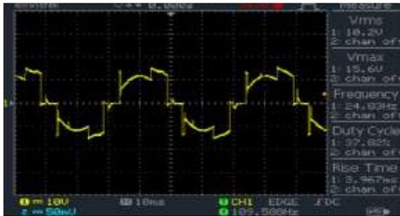
**Gambar 4** Bentuk Gelombang tegangan pada beban motor saat tegangan 102 Volt
