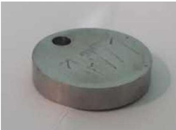
**Gambar 1.** Dimensi bahan uji titanium 6AL-4V ELI
