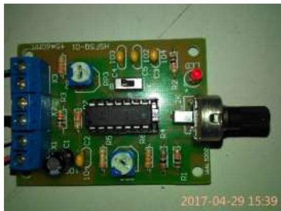
**Gambar 5.** Alat pembangkit gelombang sinus
