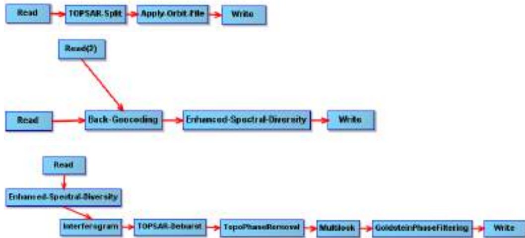
Gambar 4. Tahapan dalam pengolahan data Sentinel-1 untuk metode InSAR gempa Ambon.
