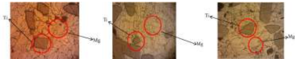
Gambar 5. Struktur Makro P-Mg 500°C (a) Bagian Permukaan Atas (b) Permukaan Tengah dan (c) Permukaan Bawah
