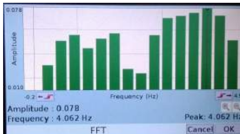
Gambar 8. Analisis FFT untuk pelat yang dibebani oleh 20 orang yang difokuskan pada daerah sekitar diatas balok anak menyilang pada pelat.
