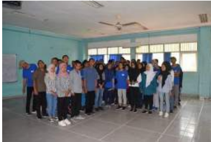
Gambar 11. Setting pembebanan untuk 80 orang ditempatkan diatas balok anak menyilang diantara tengah pelat
