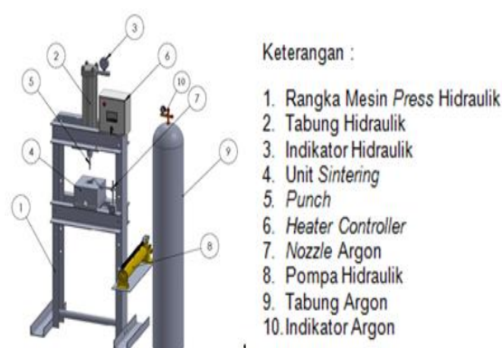
Gambar 1. Perangkat Kompaksi- Sintering ( Squeeze Casting )
