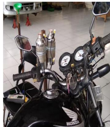
**Gambar 1.** Desain pipa spiral katalis HCS ganda pada sepeda motor Honda Mega Pro
