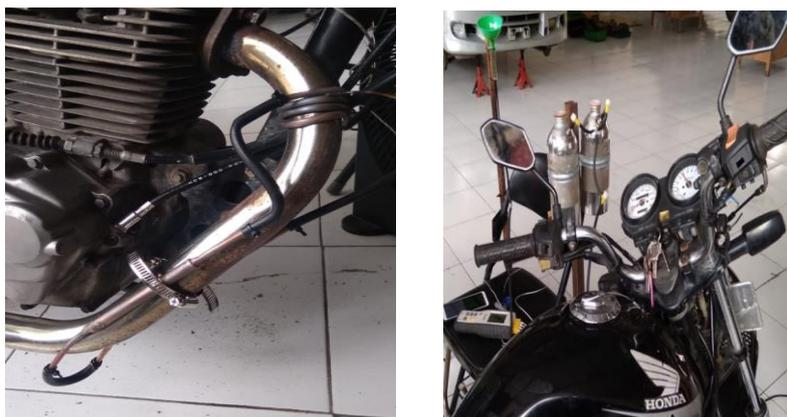
**Gambar 1. Desain pipa spiral katalis HCS ganda pada sepeda motor Honda Mega Pro**
