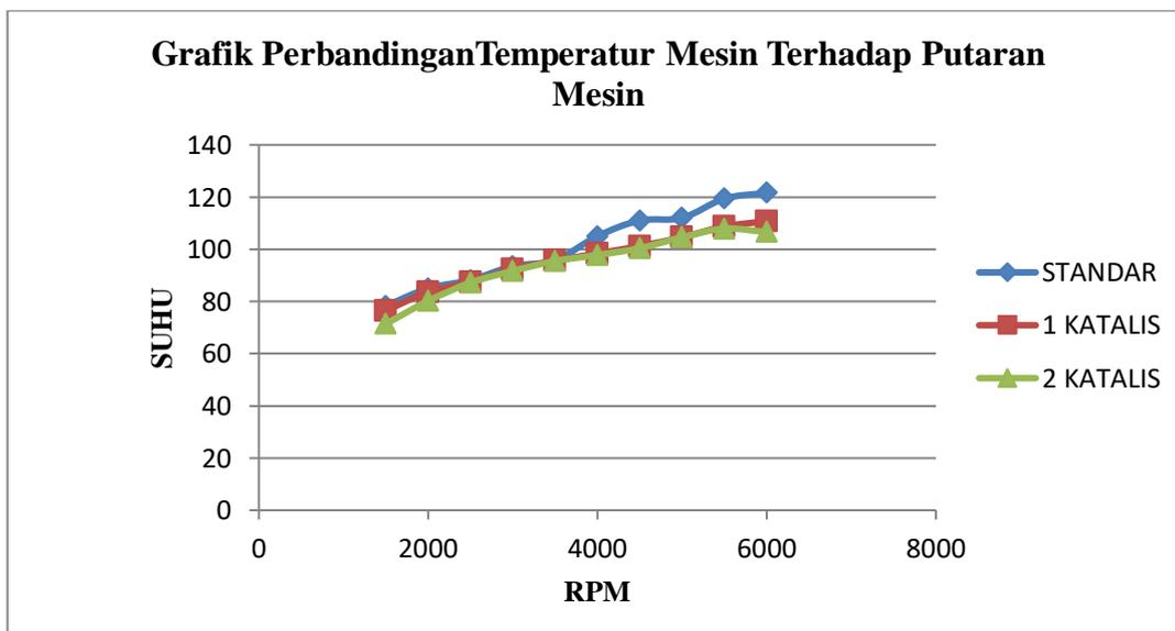
Gambar 3. Grafik perbandingan temperatur mesin terhadap putaran mesin
