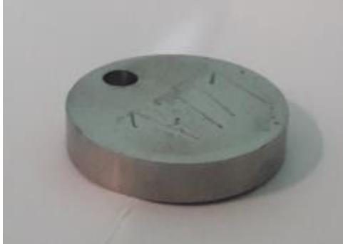
**Gambar 1. Bahan Uji Ti 6AL-4V ELI**
