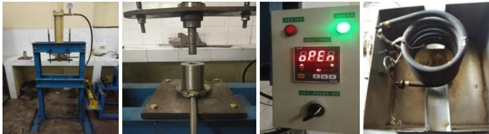
Gambar 1. Perangkat alat kompaksi dan sintering
