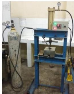
Gambar 2. Perangkat Kompaksi-Sintering (*Squeeze Casting*)
