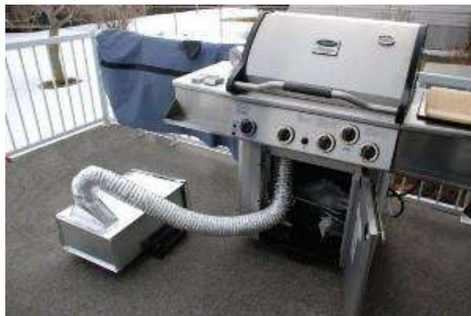
Gambar 32. Alat pengasapan elektrik
