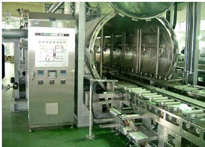
Gambar 39. Retort untuk proses sterilisasi
