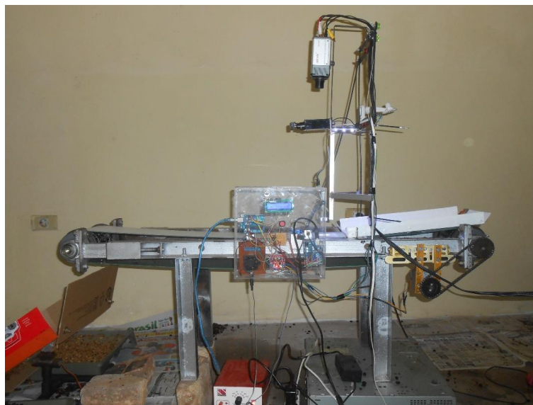
Gambar 2. Alat sistem sortir kopi sangrai yang sudah difabrikasi
