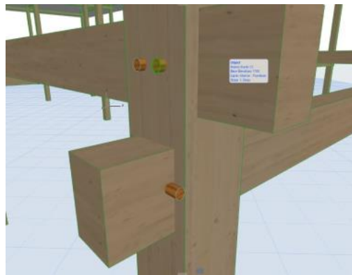
Gambar 5. Detail konstruksi kayu (sumber: Dokumentasi Pribadi)
