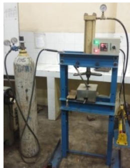
Gambar 2. Perangkat Kompaksi-Sintering ( Squeeze Casting )
