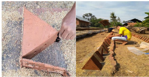
Gambar 2 Hasil Pembuatan Sampel Bata Segitiga
