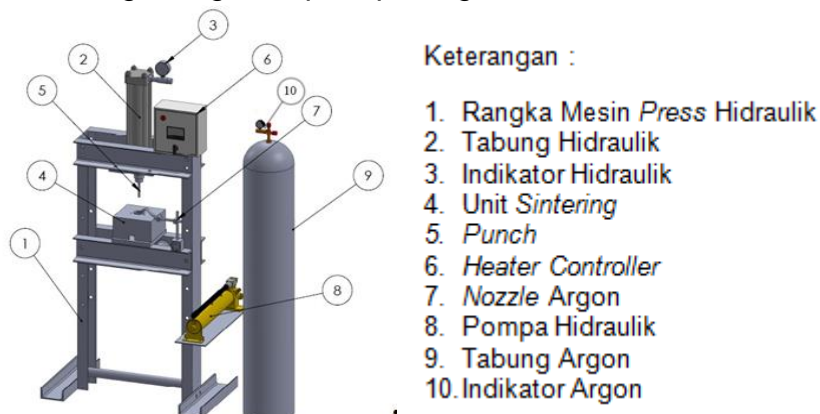
Gambar 1. Perangkat Kompaksi- Sintering ( Squeeze Casting )
