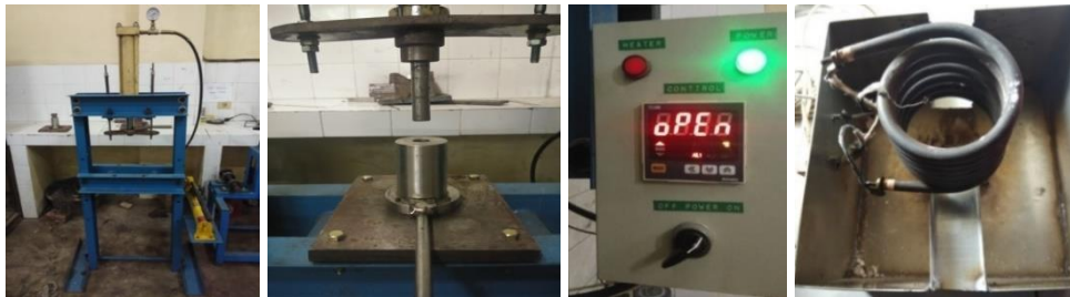
Gambar 1. Perangkat alat kompaksi dan sintering
