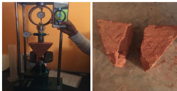
Gambar 3 Hasil Uji Tekan Bata Segitiga
