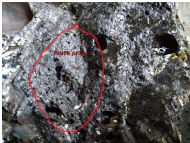
Gambar 3. Sayatan patahan produk pengecoran basalt dengan pendinginan normalizing
