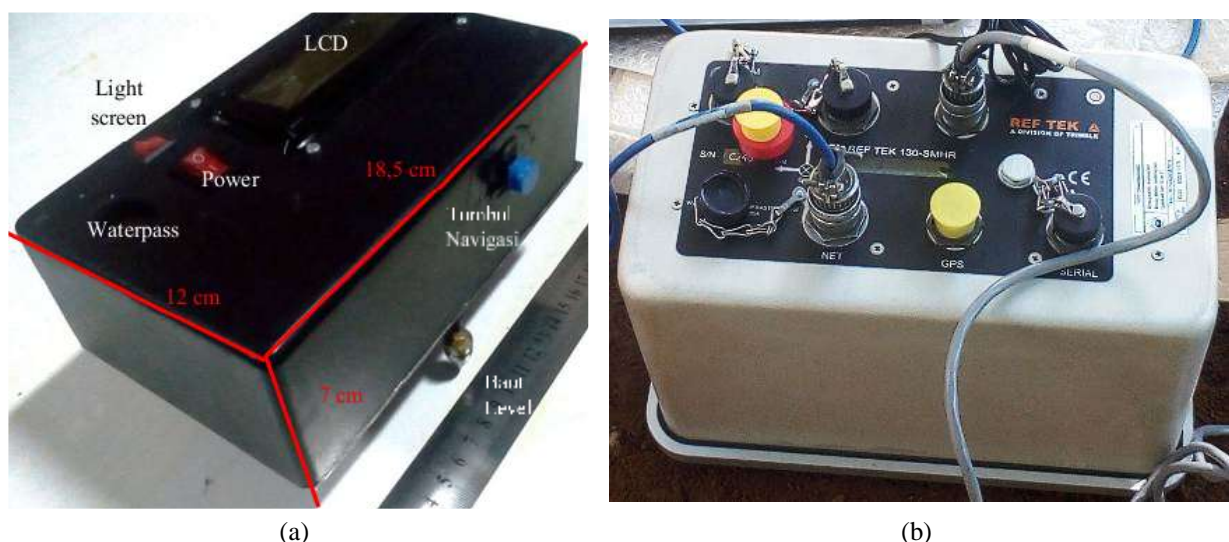
Gambar 1. Prototipe awal instrumen akselerometer dengan sensor ADXL345 yang telah dirancang dan siap untuk diuji validasi di lapangan (a). Akselerometer paten buatan pabrik SMHR-Accelerograph REFTEK (b).
