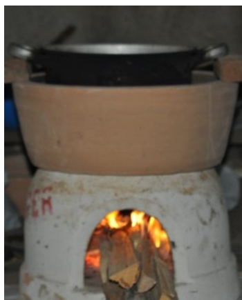
Gambar 1. Pengujian efek penambahan selimut panci terhadap kinerja tungku.
