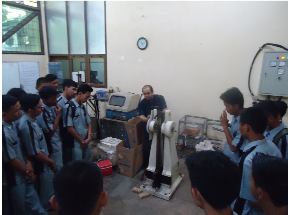
Gambar 7. Pak Zulhnif sedang menjelaskan prinsip pengujian alat uji ketangguhan Bahan kepada peserta pelatihan
