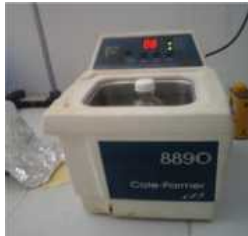
Gambar 2. Pembuatan biodiesel dengan bantuan gelombang ultrasonik
