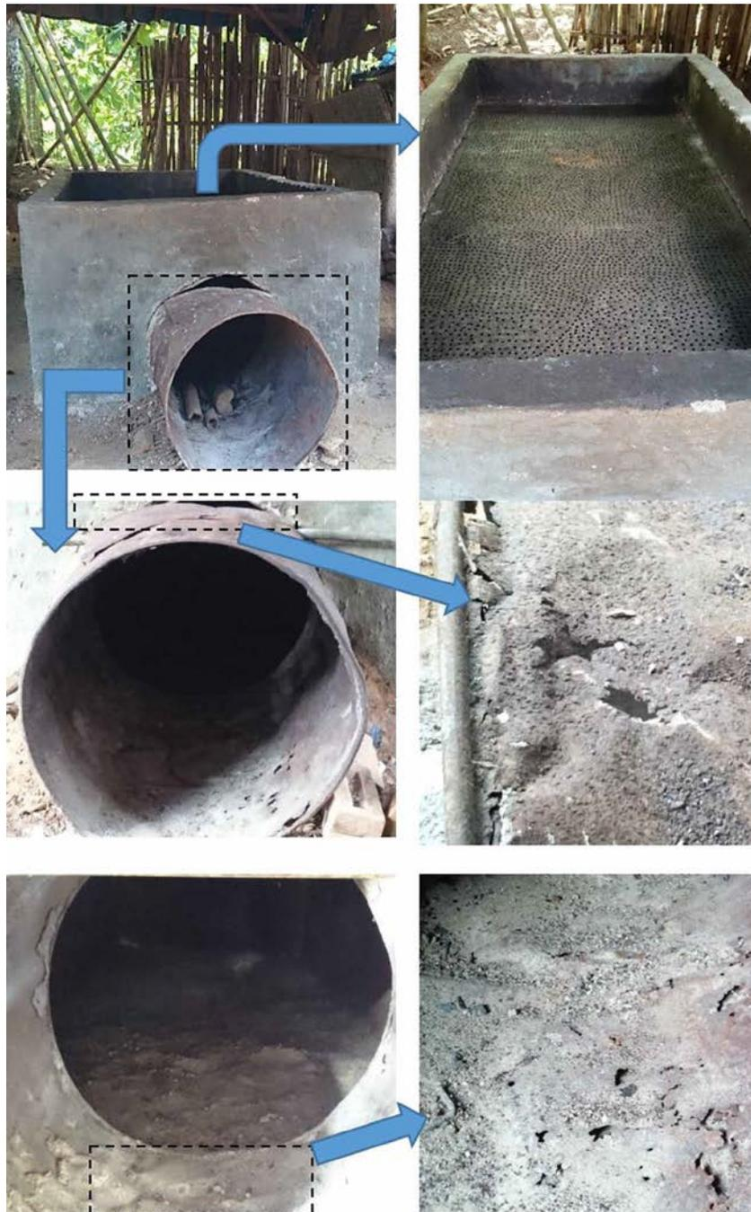
Gambar 4. Analisa foto makroskopis kondisi real tungku pengering kakao konvensional
