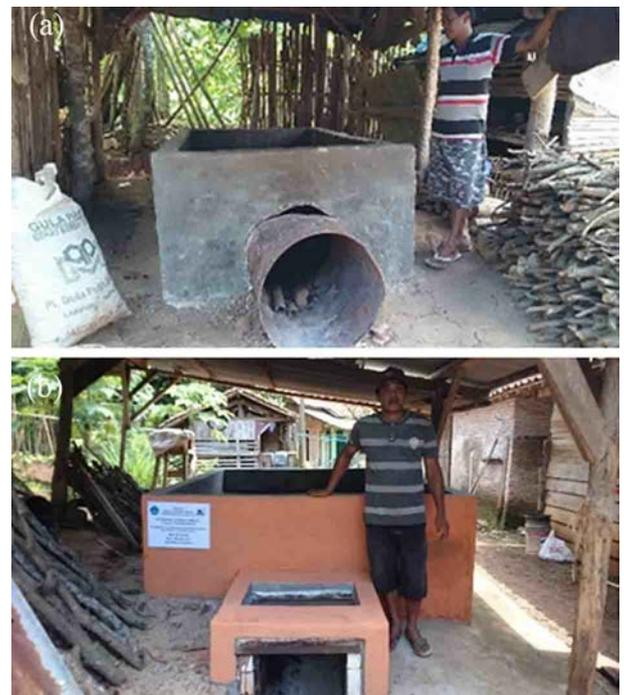
Gambar 1. (a) Tungku konvensional kapasitas 0.3 ton, dan (b) tungku modifikasi kapasitas 0.5 ton
