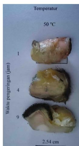
Gambar 11. Foto biji kakao yang ditumbuhi jamur setelah proses pengeringan selama 1-9 jam pada  $T = 50\text{ }^{\circ}\text{C}$
