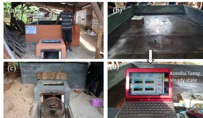
Gambar 2. (a) Tungku modifikasi, (b) ruang dan rak pengering, (c) proses simulasi pengambilan data ruang bakar, dan (d) pengukuran temperature dalam oven
