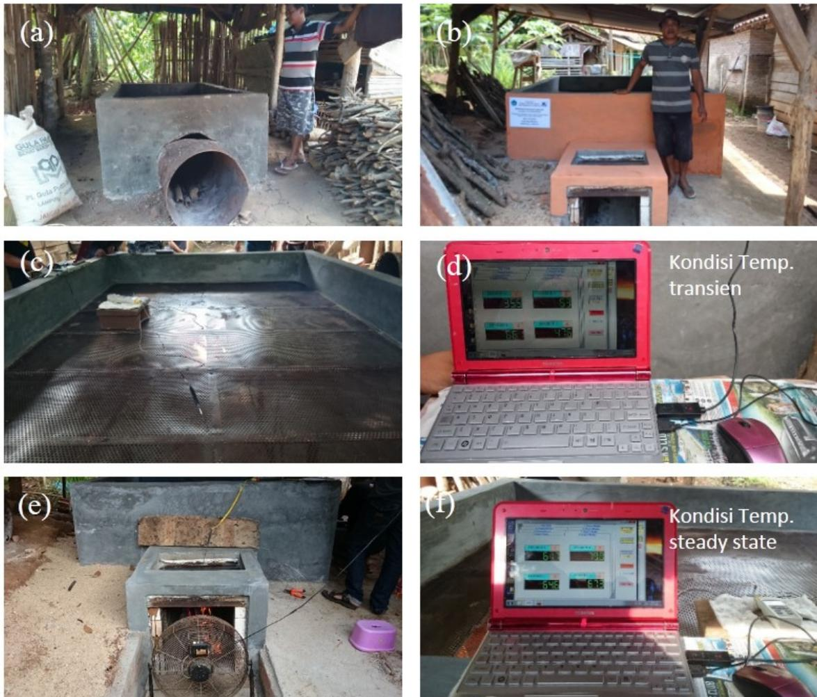
Gambar 14. Foto-foto (a) gambar tungku konvensional, (b) tungku modifikasi, (c) rak dan ruang pengering tungku modifikasi, (d) kondisi pengukuran temperatur transien, (e) pengukuran temperatur ruang bakar ( $\sim 380$  °C) pada kondisi transien, dan (f) Kondisi pengukuran temperatur pada ruang udara panas (oven) kondisi steady state
