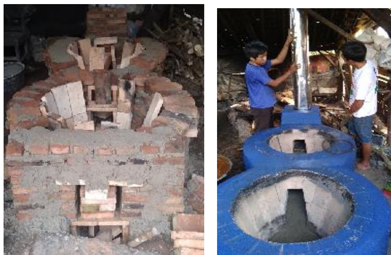
Gambar 2. Tungku Hemat bahan Bakar dan Kokoh Berbahan Dasar Batu Tahan Api SK32, Memiliki Saluran Masuk Udara Pembakaran
