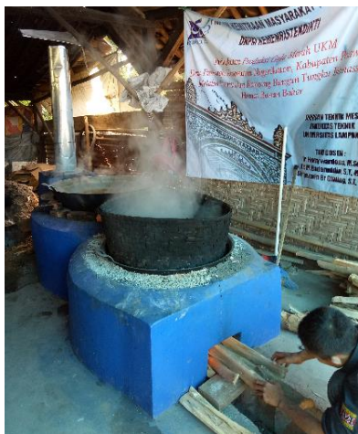
Gambar 7. Pengujian Konsumsi Kayu Bakar dan Waktu Masak Gula merah dari Tungku Batu Tahan Api SK32, juga Pengukuran Temperatur Ruang Bakar
