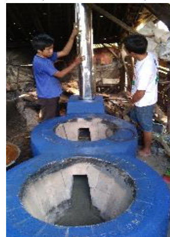
Gambar 2. Tungku Hemat bahan Bakar dan Kokoh Berbahan Dasar Batu Tahan Api SK32, Memiliki Saluran Masuk Udara Pembakaran (Wardono, 2018b)
