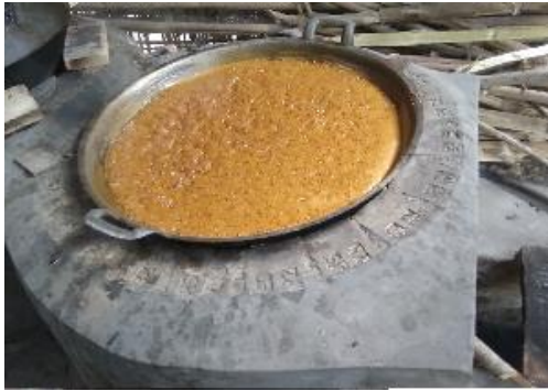
Gambar 7. Pengujian Konsumsi Kayu Bakar dan Waktu Masak Gula merah dari Tungku Batu Tahan Api SK32, juga Pengukuran Temperatur Ruang Bakar
