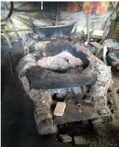
b). Dua Ruang Bakar Sederhana dan Tua, Ruang Abu Yang Tidak Memperhatikan Suplai Udara Pembakaran (Menyebabkan Api kecil dan Boros konsumsi bahan bakar)
