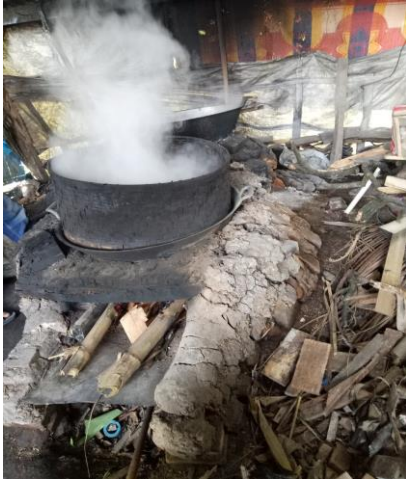
Gambar 1. Tungku Konvensional, Retak-Retak, Tidak Memiliki Saluran Udara masuk dan Gas Buang yang Layak, serta Ruang Kerja Yang Kurang Bersih dan Kurang Sehat
