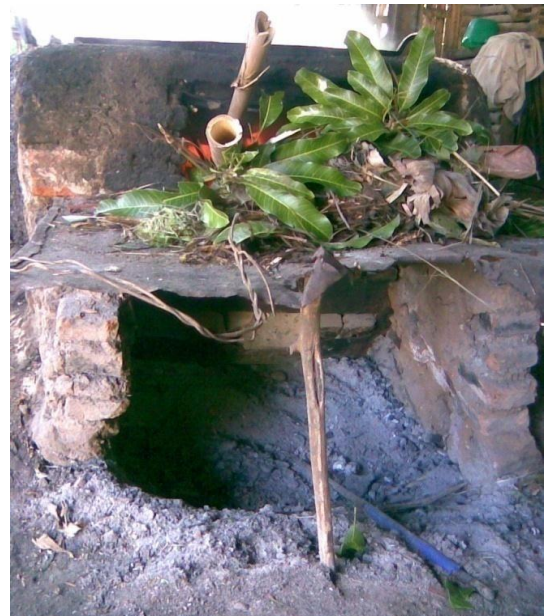
b). Dua Ruang Bakar Sederhana dan Tua, Ruang Abu Yang Tidak Memperhatikan Suplai Udara Pembakaran (Menyebabkan Api kecil dan Boros konsumsi bahan bakar)
