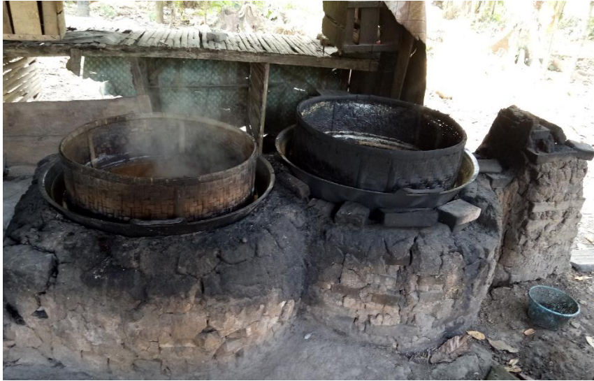
TUNGKU LAMA MITRA 2, tidak kokoh, retak & Pecah-pecah
