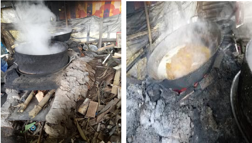
c). Tungku Sederhana, Tua, dan Tidak Memiliki Saluran Gas Buang yang Layak, Ruangan Kerja Yang Kurang Bersih dan Kurang Sehat Gambar 1. lanjutan
