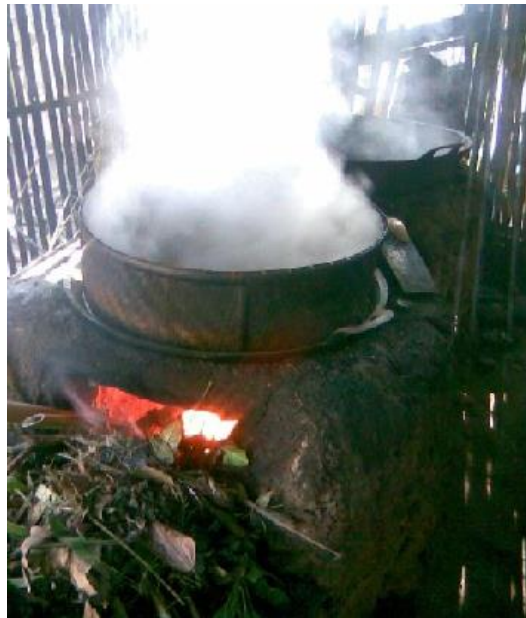
a). Tungku Sederhana, Penggunaan bahan bakar seadanya (daun basah, bambu basah, dll)
